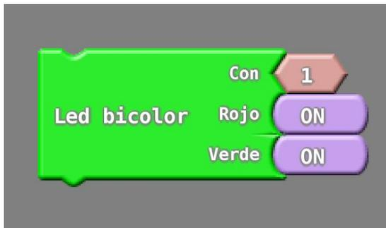
Enciende (**ON**) o apaga (**OFF**) respectivamente los leds rojo y verde contenidos en el módulo Led bicolor.
