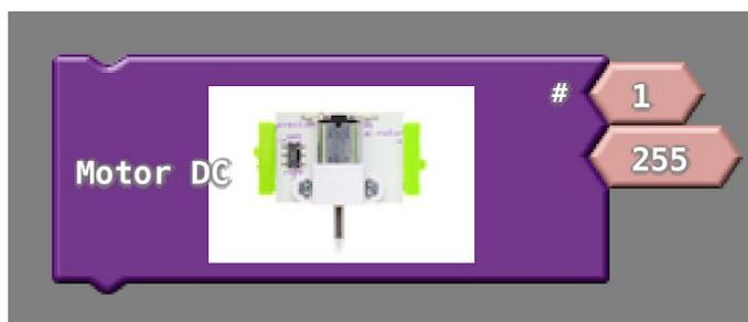
Estos bloques harán que el módulo realice acción de (movimiento, sonido o luz (según corresponda) con una intensidad determinada de **0 a 255**.
