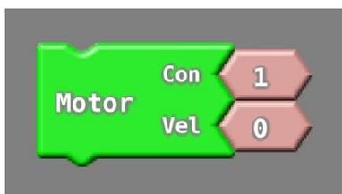
Asigna la velocidad al motor conectado al **Con** donde conectemos el módulo.
