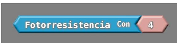
Indica la luz que recibe el módulo **Sensor de luz** con un valor entre 0 (oscuridad) y 1023 (máxima luz recibida). **Con** es el número de conector donde conectemos este módulo.
