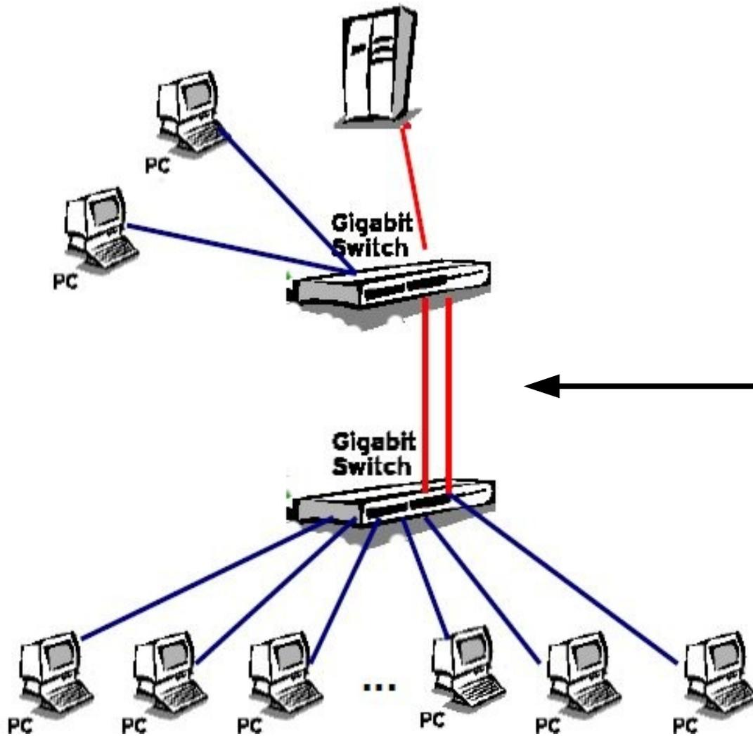
La solución es emplear trunking de puertos para unir múltiples conexiones y emplear el ancho de banda combinado como si fuera uno solo
